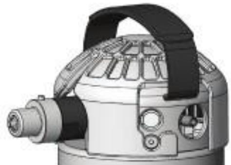
8. Das tragbare System in der Befüllungsposition halten und dabei den Entlüftungshebel in die geöffnete Position ziehen (Abbildung 1). Es sollte ein Zischen zu hören sein.
